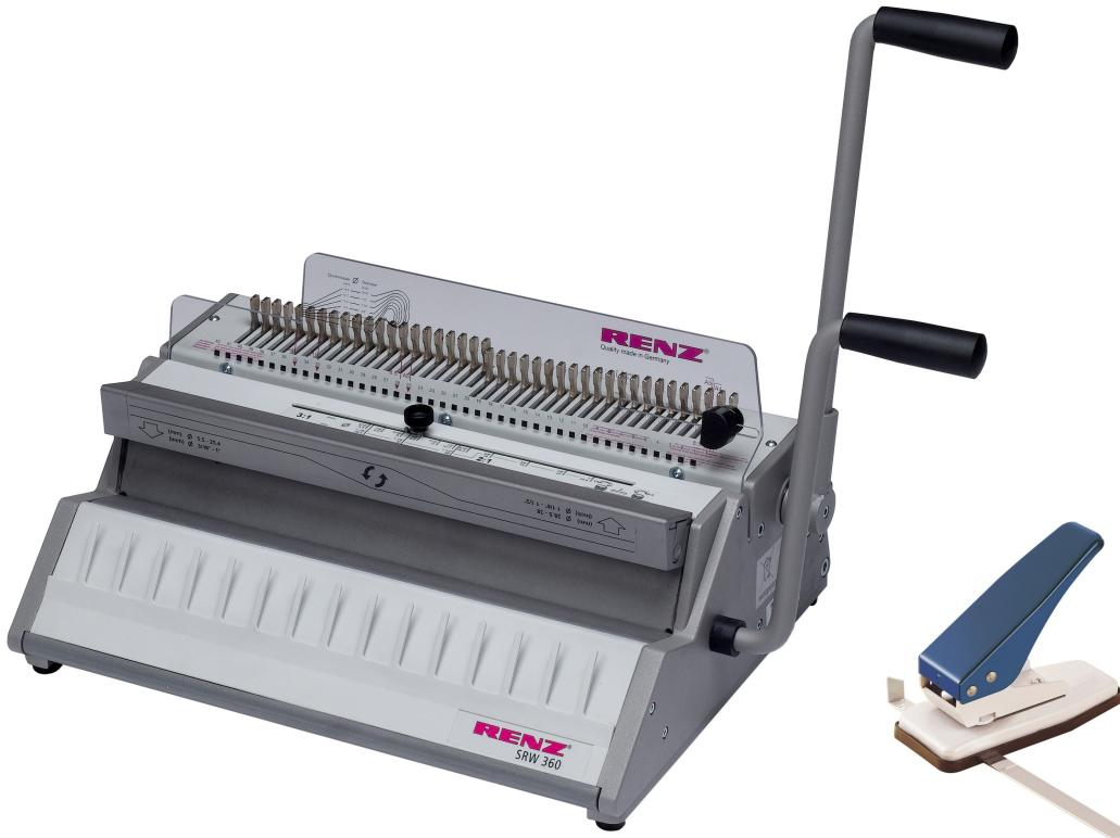
Inovovaná verze vysoce kvalitního vázacího a děrovacího stroje. Určen pro vazbu do kovových hřbetů s roztečí ok 3/1" (5,5 mm - 16 mm). Otevřené postranice pro možnost vazby větších formátů než A4. Vhodný pro vazbu svazků do cca 130 listů. Optimální pro malonákladou vazbu kalendářů ve spojení s výsekovým nástrojem CPW20, který je dodáván v setu s vazačem SRW 360. Nástrojem CPW20 vyskněte do svazku půlkulatý výsek pro kalendářový háček.
